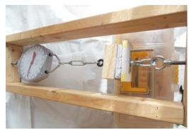
同じL型金具真ん中にアイボルトを取り付け、面に垂直方向に引っ張った時は100kgfでも安定して保持されている。
