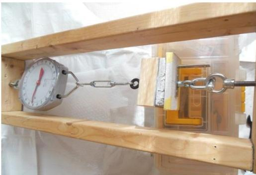
同じL型金具真ん中にアイボルトを取り付け、面に垂直方向に引っ張った時は**100kgf**でも安定して保持されている。
