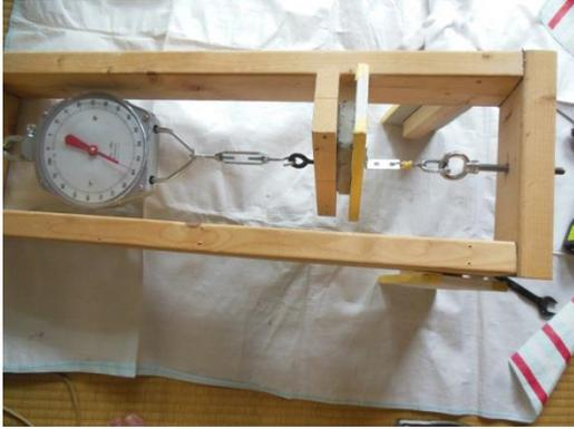
左より100kgバネ計り(滑車二連にて200kgまで計測)
